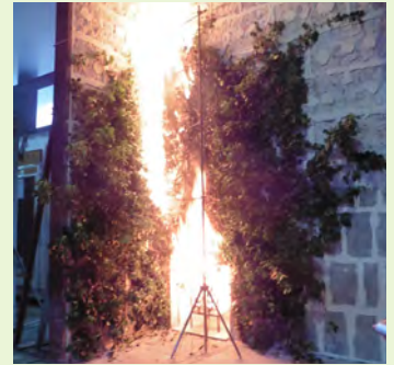
Kurzzeitige vertikale Brandweiterleitung während der Brandprüfung
