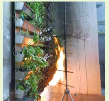
Flammenhöhe erreicht ca. 1,7 m von Sturzoberkante während der Brandprüfung
